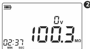
Не прикасайтесь к открытым токоведущим проводникам сразу после измерения, электрический заряд, накопленный в цепи, может привести к поражению электрическим током.
